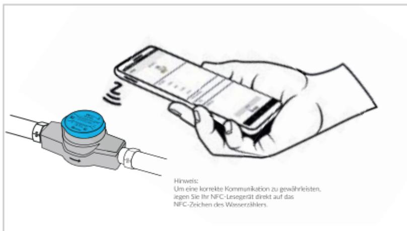
Die NFC-Schnittstelle im Wasserzähler befindet sich über dem Display auf der oberen rechten Seite der Gehäuseoberseite.
