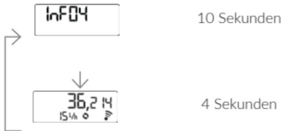
Kommt es im Zähler zu einem Ereignis oder Fehler, so wird dies mit einer Meldung auf dem Display angezeigt. Dabei wird die Darstellung der Ereignismeldung für 1 Sekunde in die Anzeigenschleife eingebaut. Die Ereignisse 01 bis 06 und 08 werden zusätzlich im Funktelegramm übertragen.
