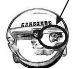
3. Setzen Sie das Modul auf die Haube. Kontrollieren Sie den korrekten Sitz des Moduls (ebener Übergang zur gewölbten Fläche der Haube!).
